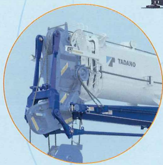
低位置において安全にテンションロッドの接続が完了。
