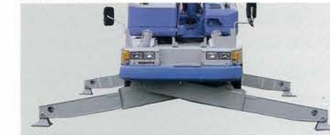
▲4節リンク式X型アウトリガ
