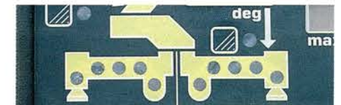
▲アウトリガ張出幅自動検出装置
