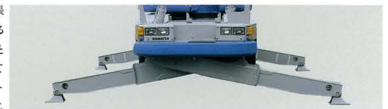
▲アウトリガ張出幅自動検出装置
