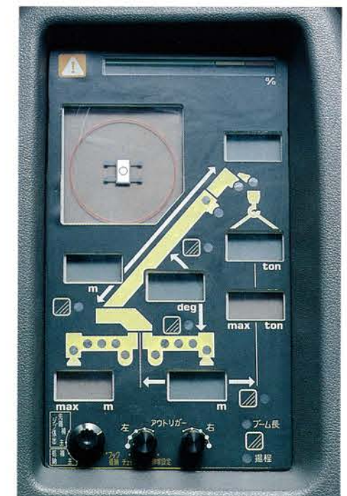
▲OSSパネル イラスト表示パネルには、安定度(モーメント%)・ 起伏角度・ブーム長・実作業半径・定格作業半径・実荷重・ 定格総荷重・最大地上揚程を見やすく表示します。
