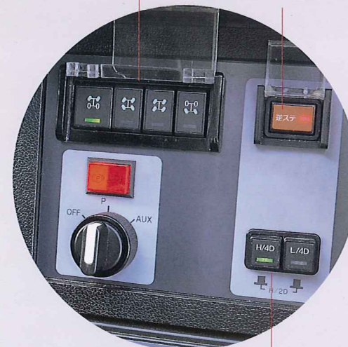
4モードステアリング選択スイッチ 逆ステアリング補正スイッチ
