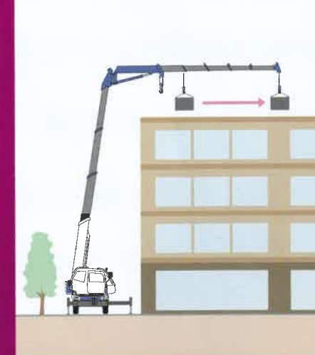
ビル屋上への送り込み作業例
