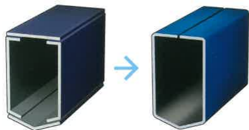
タワミ、ブレに強い五角形(ペンタゴン)の断面形状。
